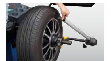
ゲージを当てるだけで、リム幅を自動入力
