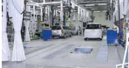
5つのラインの最初のストールにはすべて車体修正システムを設備
