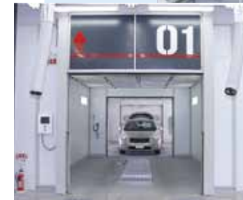
塗装ブースから乾燥ブースへ、 ドアの開閉だけで移動できる
