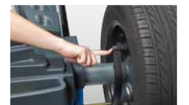
ゲージを当てるだけで、ディスタンス、 リム径を自動入力
