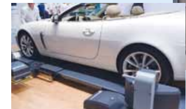
バイパスの「タッチレス」非接触アライメントテスター
