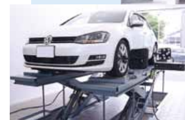
バイパス「イージー3D」で正確な アライメント測定が迅速に行える
