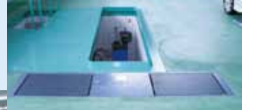
サイドスリップテスターを設備し、 オイル交換時の点検サービスも 付加価値アップ
