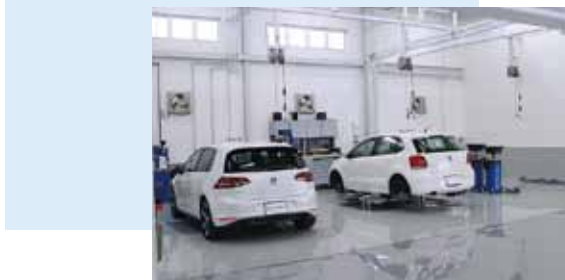
安全、効率的な作業が行えるタンデムリフトを導入
