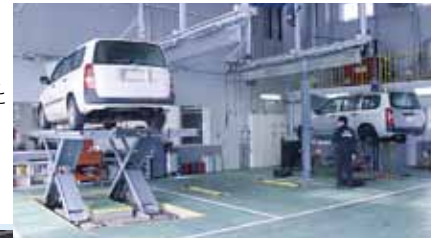
ストール間には下回り塗装のミスト防止カーテンを設置、排気ホースリールも完備
