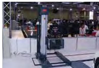
画像処理式全自動ヘッドライトテスター(バッテリータイプ)「HT-528B」。
