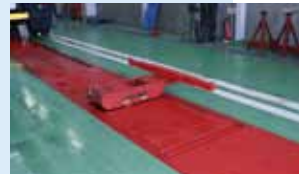
独自開発のエアサス車専用アタッチメント。 ペローズの損傷を防止。
