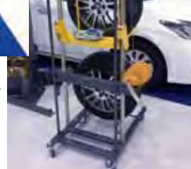
タイヤサービスの省力化、効率化を実現する「タイヤリフター」。
