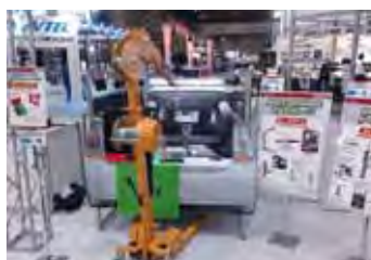
HVのバッテリーなど重量物の脱着、移動が安全に行える「マルチクレーン」。
