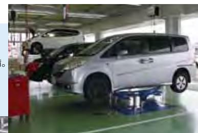
サービスストールには タンデムリフト3基、 Zイーグルリフト2基を設備。
