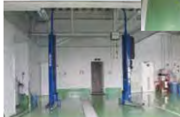
ゲートリフトⅢを設備した洗車、下回り塗装ストール。
