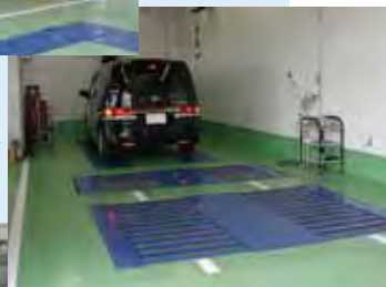
ワークステージX、 固定式フリーローラーを 備えた検査ライン。
