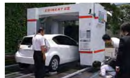
最新型門型洗車機「エminentαIII」と下部洗浄機の組み合わせで強力洗車。
