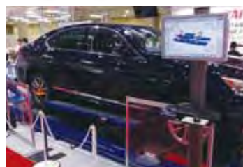
リフトで車体を支えるため、ベルト等で固定することなく、運行支援システムなどの診断が走行状態で安全に行える「MAHAテストベンチ」。
