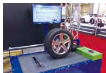
通過するだけで溝の深さを測定できるタイヤ溝測定器。
