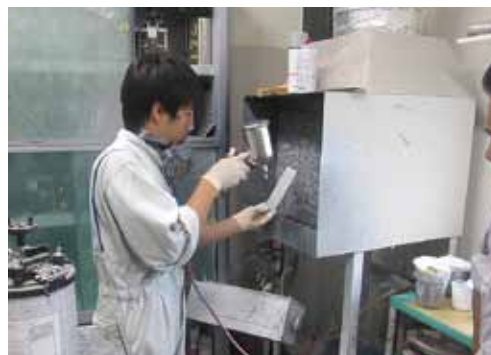
スプレーキャビンでテストピースの塗装
