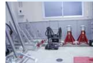
各種ヨサムシステムを完備。上下、左右曲がり修正に対応。
