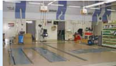
ストール前面にはオーバースライダー、下り壁でダクトを隠し、すっきりしたデザインに。
