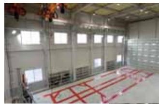
板金ストールにはヨサム修正システムのフロアレールを敷設。天井クレーンは2基4台、隅々まで移動可能。
