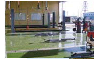
ネオパスカルリフト(シリンダー埋設2柱リフト)、四柱式ワークステージFをそれぞれ2基導入
