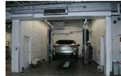
洗車ストールにはゲートリフトⅢ(洗車仕様)、温水洗浄機ナイスホットを設備
