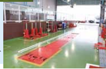
小・中型車ストールにはキャタピラツインIIミニを2基設備、通り抜けとしている
