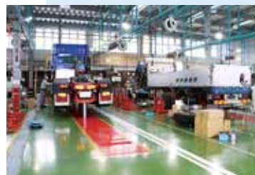
キャタピラツインIIが2基、フラットキット付で安全、効率的な作業を実現
