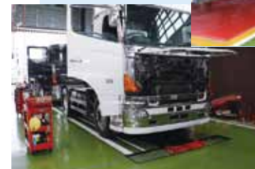
小・中型車ストールにはキャタピラツインIIミニを2基設備、通り抜けとしている
