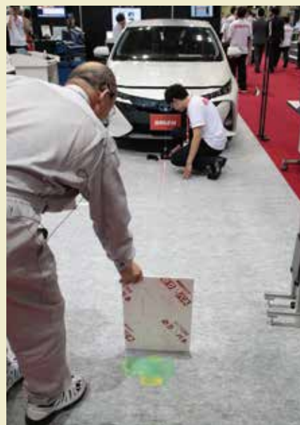
オートサービスショー2017のバンザイブースで開催された「ASVエーミングセミナー」におけるエーミング作業実演の様子。車両のセンター出しには開発中の「センターサポートナビ」を使用した
