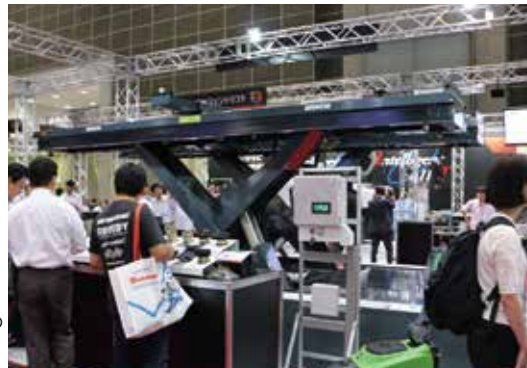
能力5ton、ドライブオンタイプの 「フラットワークステージ」
