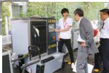
水圧とプラスチック粒子で ホイールを強力洗浄(参考出品)
