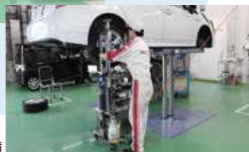
ハイパー車検専用台車と専用のホースリールを設備
