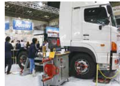
大型車用アライメントテスター「カムアライナー」 大型車への先進安全技術搭載によるアライメント測定・ 調整の重要性がますます増加
