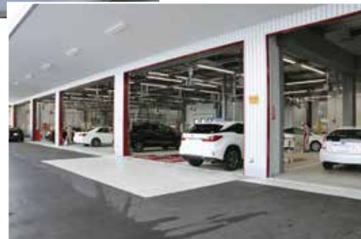
板金から塗装工程へ、手前から奥へ向かう工程レイアウト
