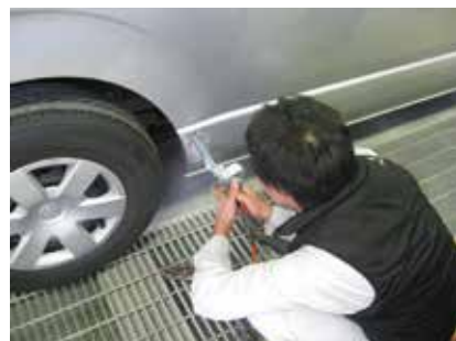
ベルトサンダーによる塗膜のサンディング指導
