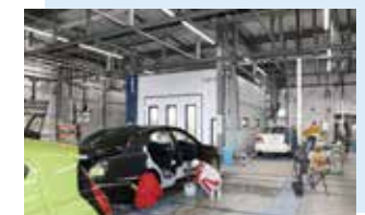
床面集塵装置で粉塵の飛散が少ない快適環境を実現
