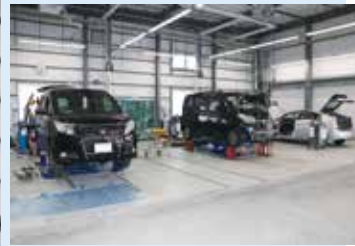
車体修正エリアには床式ボディ修正システムが3基。リフト仕様で様々な場面で威力を発揮
