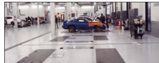
16スToolのリフトは全て埋設型のフラットタイプを設備しています。
