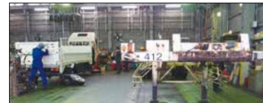
揚程1.6mの仕様にしたプラトニリフトを2基設備しました。
