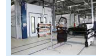
ライン左側の塗装・乾燥ブースは、水性対応の加湿・温風発生仕様
