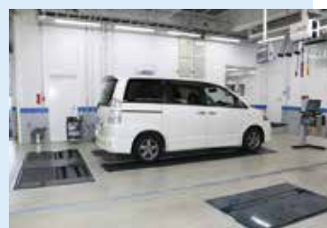
検査ラインにはトリプルテスターと ワークステージXを設備
