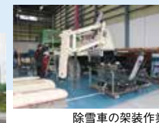
除雪車の架装作業
