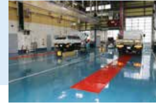
4柱式ツインエース、前後2台の作業も可能
