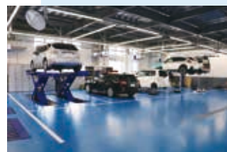
工場左側の車検、一般ストール。 すべてフラットタイプのリフトを導入
