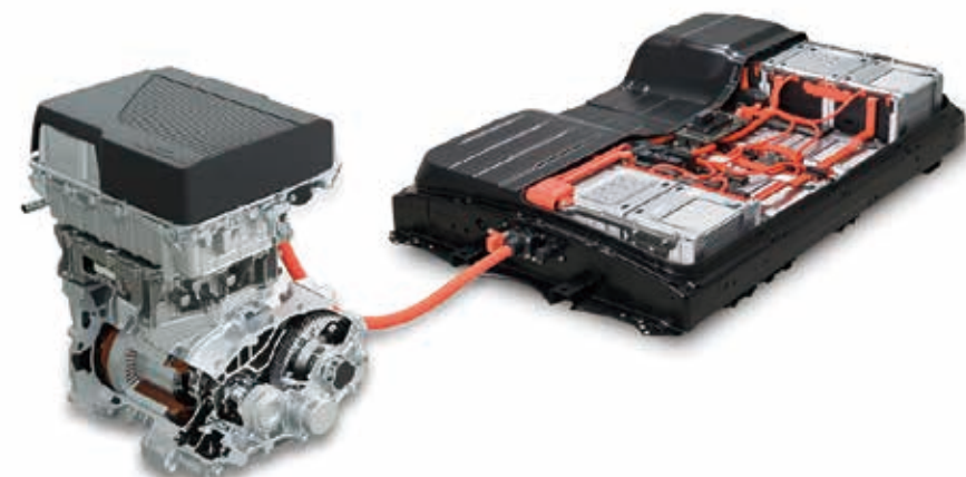
日産リーフe+のパワートレイン。ピュアEVのためエンジンは搭載されておらず、エンジンオイルやフィルター、スパークプラグも存在しないため点検・交換も不要となっている
