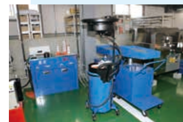
ドレンボックスで廃油、廃LLCを回収
