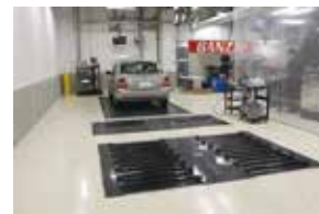
検査ラインにはネットワーク、固定式フリーローラーを設備
