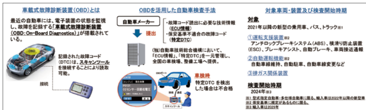
「OBD検査」の概要 (出典：国土交通省「車載式故障診断装置を活用した自動車検査手法のあり方検討会報告書(概要)」)
