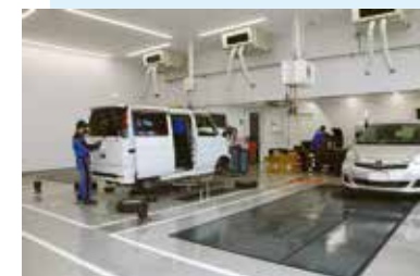
クイックストールにはフラットワークステージX 5t、タンデムリフト、イーグルFXを各1基導入
