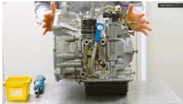
レベルゲージ付きAT-CVTはレベルゲージ用の配管がケースから伸びているが、レベルゲージレスのAT-CVTでは配管が省略されている
