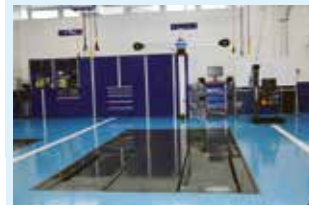
ジオライナーでホイールアライメントを精密、迅速に測定できる。
