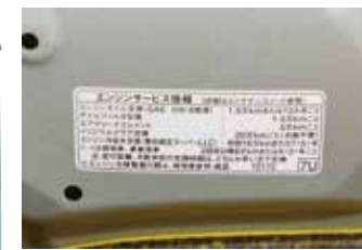
推奨エンジンオイル粘度を0W-8とする新型トヨタ・ヤリスハイブリッドのコーションラベル。「トヨタ純正モーターオイル GLV-1 0W-8」もヤリスハイブリッドと同時に発売された
