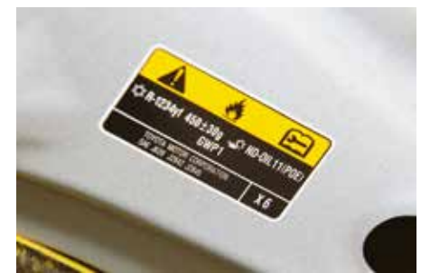
エアコンに新冷媒R-1234yfを用いるトヨタ・ヤリスハイブリッドのコーションラベル。指定コンプレッサーオイルはPOE
