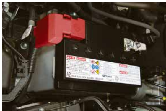
EN規格バッテリーは端子の位置が蓋より低く、バッテリー全体の高さも低め
