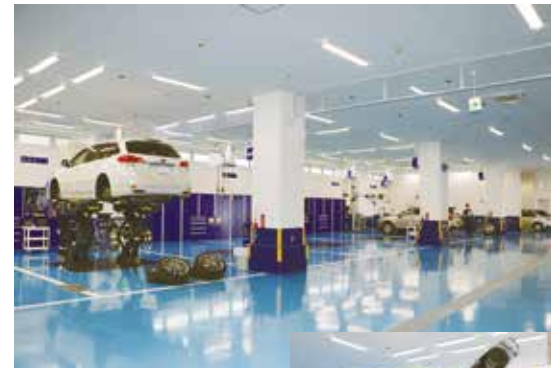
イーグルFXリフトを5基設備。ストール幅も広く作業性アップ。ストール後方にもリールを設備し、2名作業を容易に。
