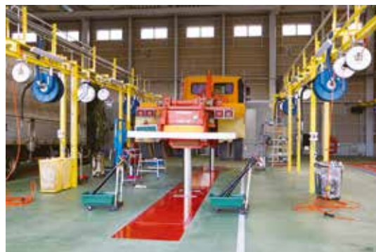
ストールの前後にバキューム吸塵装置のリールを配置。
