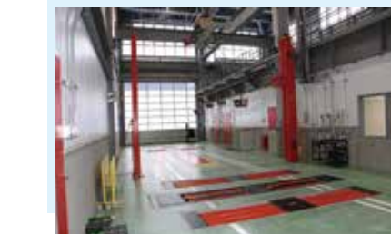
東側の検査ライン、荷重試験機、車高測定装置も導入。
