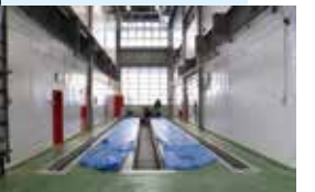
左側洗車ストール、自動下部洗浄機、側面洗浄機を備え、洗車の作業負担を大幅に軽減。
