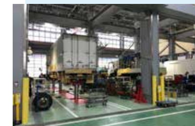
4柱式ツインエースが5基。入庫台数の多い中・小型車は前後に2台同時サービスが可能。
