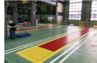
道内初の3分割フロアリフトを設備。ピットは2ストール共通として幅広い整備に対応。
