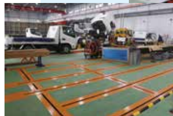
あらゆるフレーム修正に対応するフロアレール式修正システム
