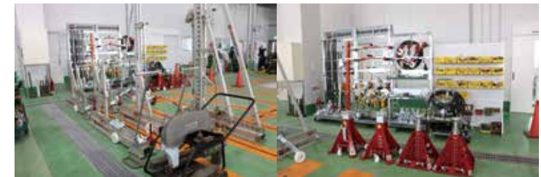
ヨサム修正システムでフレーム、キャビンも精密なフレーム修正を可能に
