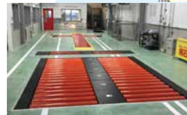
西側の検査ライン。超ロング仕様の固定式フリーローラーでフォワードの4輪駆動車にも対応。
