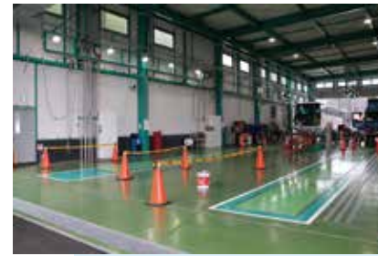
2ストールにフロアリフトを導入、ピットは一体として作業性を向上
