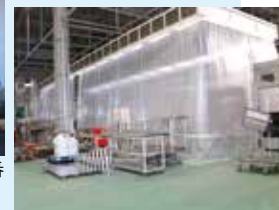
各レーンとも手前にカーテンブース、奥側にプッシュプル式ブースを配置。
