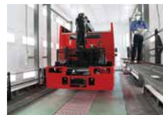
ブース内の両側に作業用リフトを装備。
