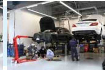
タンデムリフトはすべてメルセデス・ベンツに適したフラットアーム式。
