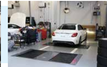
トリプルテスター、固定式フリーローラーを設備した検査ライン。
