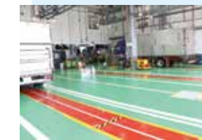
一般整備ストール南側の3ストール。 キャタピラツインII2基、2分割フロアリフトを設備。
