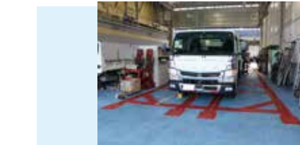
各種の車体修正に対応するフロアレールを敷設。
