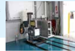
検査ラインは2レーン。荷重試験機のほか、車高測定装置、車体計測装置などデジタル機器も導入。
