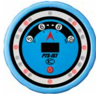
ホイールナットに取付けた「インストラクター」が締め付けの順番をLEDの光で案内。
