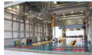
検査ラインは2レーン。荷重試験機のほか、車高測定装置、車体計測装置などデジタル機器も導入。
