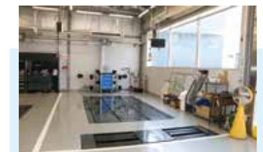
ジオライナーで迅速、精密なアライメント計測に対応。検査ラインとは別にコンビネーションテスターも設備。
