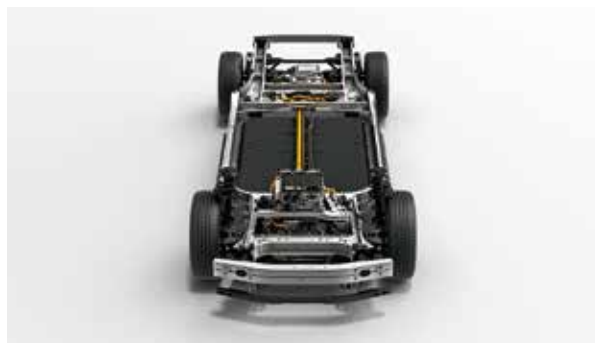
BEVのパワートレイン (写真はトヨタbZ4X)
