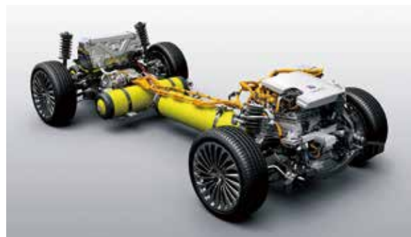
FCVのパワートレイン (写真は現行2代目トヨタ・ミライ)
