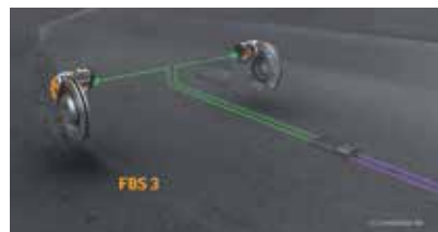
フロントディスクブレーキも電動機械式とし油圧システムを完全に廃止したコンチネンタルの「FBS3」
