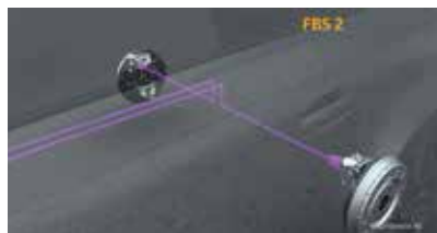
リヤドラムブレーキを電動機械式とし油圧システムを廃止したコンチネンタルの「FBS2」
