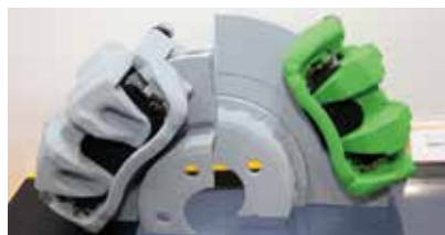
フロントブレーキ全体を小型化のうえローターを大径薄肉ソリッド化したコンチネンタルの「グリーンキャリパー」(写真右側)。左側は既存の一般的なフロントブレーキ
