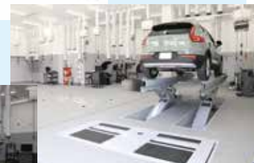
検査ラインにはトリプルテスター、ワークステージX・4トン仕様を導入。
