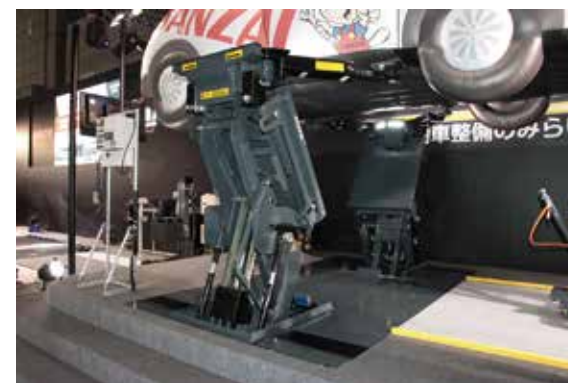
BEVの整備にも柔軟に対応できる能力4tのパンタ式アームリフト「イーグルアドバンスリフト」
