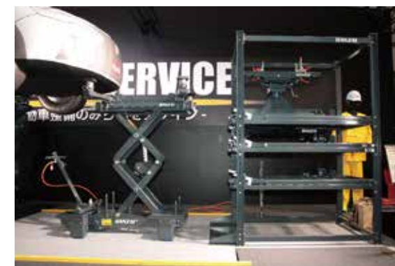
BEV駆動用バッテリーやエンジン・トランスミッションの脱着にも使える「ユニバーサルマルチリフター」
