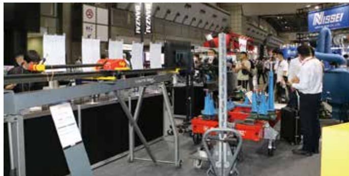
3D車体計測システム「ナジャ」と、連携して高精度修正を行えるジグシステム「カメレオン」。
