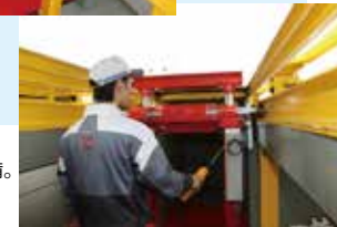
ホイール脱着等の作業に、2柱式ピットジャッキを装備。
