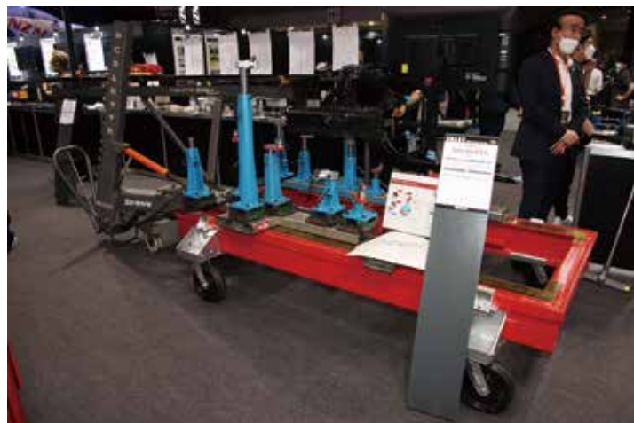
多様な素材・接合技術を用いた車両の高精度な位置決め・修正が可能なユニバーサル式ジグシステム「セレット・カメレオンプラス」
