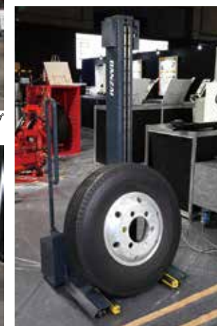
新コンセプトのタイヤリフター「ハイスピードタイヤリフター」(参考出品)。
