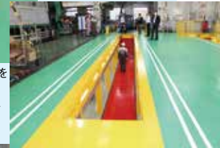
2分割式、3分割式フロアリフトを各1レーン。各レーンはピットで連結し作業性、安全性を向上。
