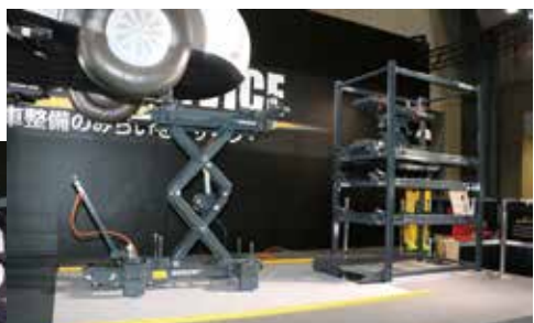
今後増加するEVバッテリー、トランスミッションなどの脱着に対応するユニバーサルマルチリフター。(参考出品)
