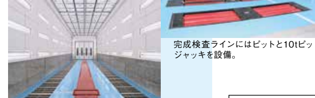
塗装ブースは建屋一体型。下回り塗装に有効な防爆型ツインエースを設備。
