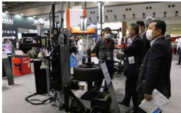
ユニフォーミティ診断機能付きR-UNFタイヤチェンジャー。
