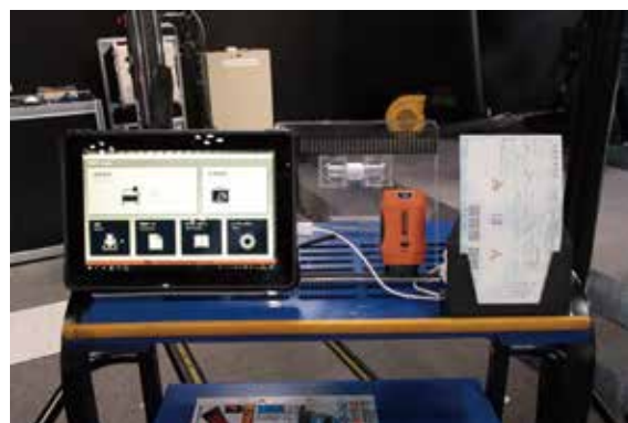
「検査用スキャンツール」の型式認定第1号を取得し「整備用スキャンツール」の技術要件にも適合する汎用スキャンツール「MST-nano」
