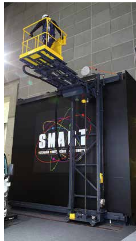
エア駆動、ネジ軸による安全な昇降が可能な「モバイルプラットフォーム」。
