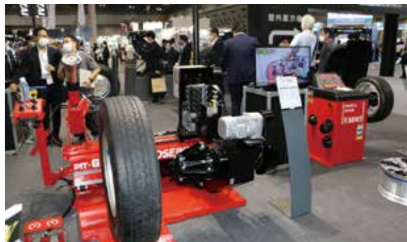
大型車タイヤチェンジャーも省力化、自動化へ、セミオートPIT G-50Vチェンジャー。
