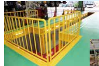
2分割式、3分割式フロアリフトを各1レーン。各レーンはピットで連結し作業性、安全性を向上。
