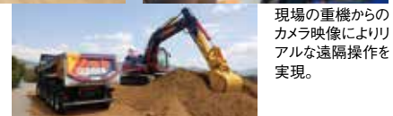
主力となる28トンダンプトレーラーと遠隔操作の「5G」パワショベル。
