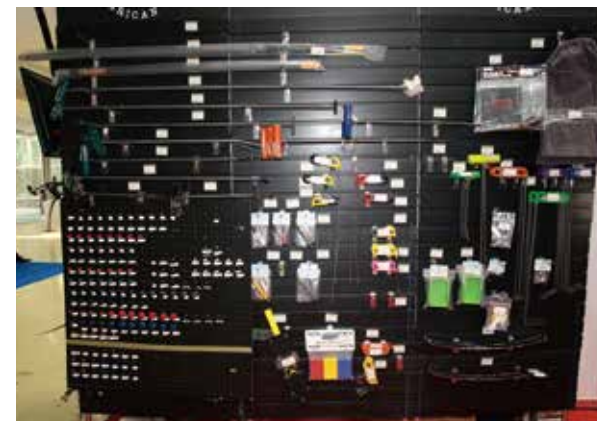
ペイントレスデントリペアでは棒状のツールなどを駆使してボディの内側から凹みを押すことで損傷を修復する
