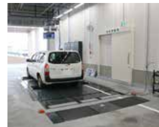
検査ラインにはスーパーマルチテスターを導入。4WD車の検査も容易に。
