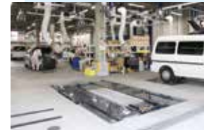
EV時代にも必須のアライメントに、ワークステージXを導入。
