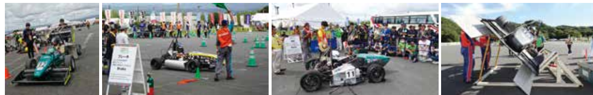
車検では安全性、ブレーキ、騒音、排気ガス、傾斜テストなどを実施。
