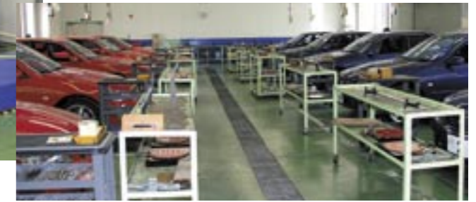
埋設式オートリフトがずらりと並ぶ2号館シャシ実習室
