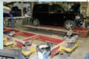
大ダメージも正確に復元できるセレットベンチが2基
