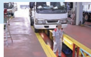
ピットフロアリフトは入庫も容易、クイックサービスにも対応
