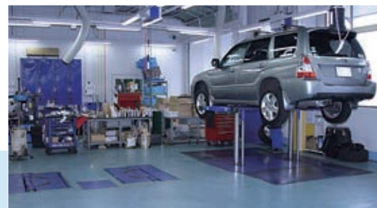
低床車やスポイラー装着車も容易にリフトアップできるエアロパスカリフト(右)
