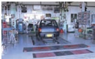
検査ライン、アライメントテスター「バイスパス」。アライメントテスターのアタッチメントは吊下げボードに収納
