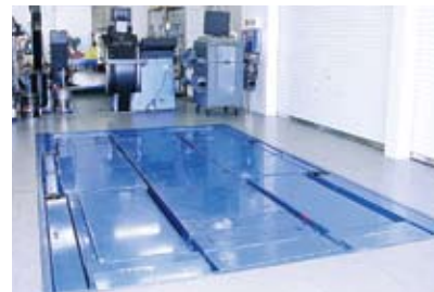
マイクロラインとワークステージリフトを導入したアライメントストール
