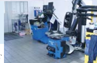
ホフマンのチェンジャー、バルンサーで足回り整備
