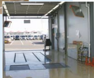
通り抜け式の検査ライン、トリプルテスターとワークステージリフトを導入
