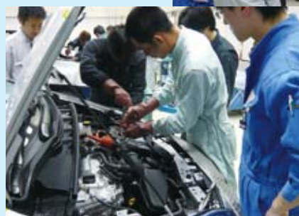
絶縁手袋を装着して実車によるインバーターの取り外し実習
