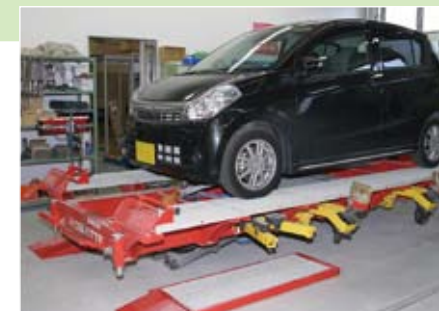
ドライブオン式のセレットグリフォンであらゆるダメージに対応
