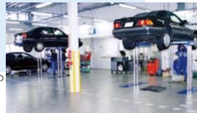
両側ストールにタンデムリフト14基を設置
