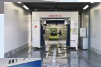
洗車棟には門型洗車機を導入
