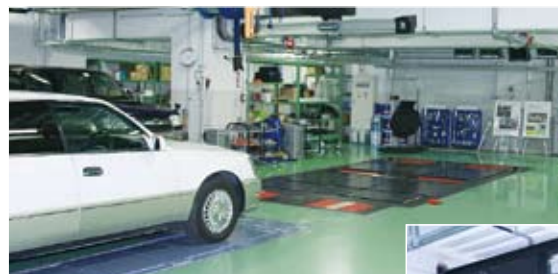
スーパーマルチテスターを 導入した検査ライン (B1)
