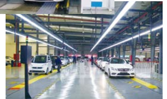
スラットコンベア上で流れ作業で点検整備を実施
