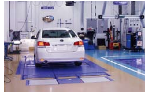
検査ラインにはフルタイム4WD対応の スーパーマルチテスター、 ネットワークワイジーを導入
