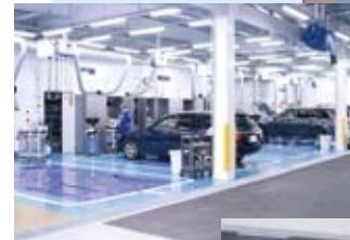
光学式・3Dアライメントテスター 「ジオライナー」、 フラットワークステージXを 導入したアライメントストール
